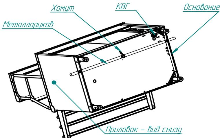
В основаниях изделий линии раздачи введено сквозное отверстие диаметром 29,5 мм и поддерживающие хомуты для возможности проведения металлорукава с питающими кабелями сквозь все изделия линии раздачи.
